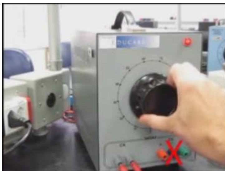
Figura 6: mostra como conectar o equipamento sob teste na fonte de tensão variável, chamando a atenção para sua correta conexão. A voz e símbolos auxiliares (X) são usados para esclarecer o uso correto do equipamento.
